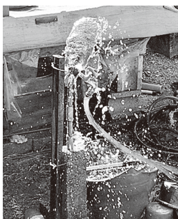
凍結による破損漏水
