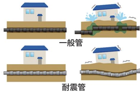
耐震管への更新は、地震の際の被害を抑えることに有効な手段の一つで、更新が急がれています。
